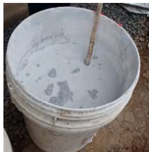
水酸化カルシウム水溶液 (酸化カルシウム＋水道水)
