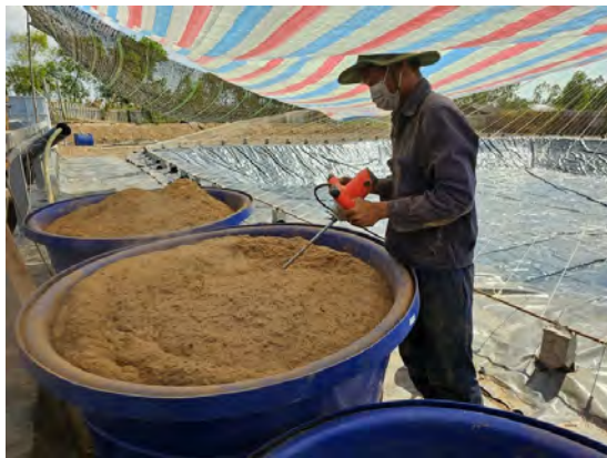
汚泥とレモングラス粉末、 水酸化カルシウム水溶液の混合前
